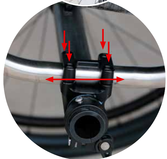
Lossa de fyra skruvarna på båda sidor. Skjut sedan fästet framåt eller bakåt.
